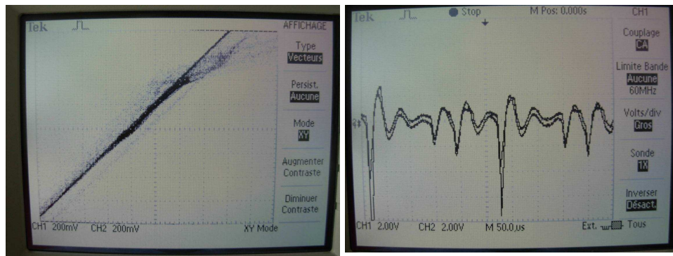
FIG. 4.6 – Résultats de la synchronisation, V_{C_1} et V_{C_3} vus en mode X-Y à gauche et en fonction du temps à droite (avec un léger offset sur la voie 1 pour une meilleure distinction).
